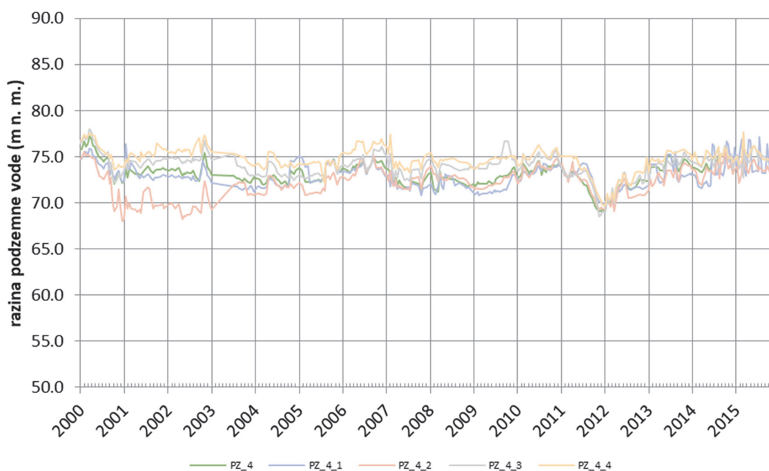
Slika 9. Kolebanje razine podzemne vode po profilu vodonosnika na lokaciji piezometarskoga gnijezda PZ-4 smještenog između zdenaca Z-14 i Z-15.
