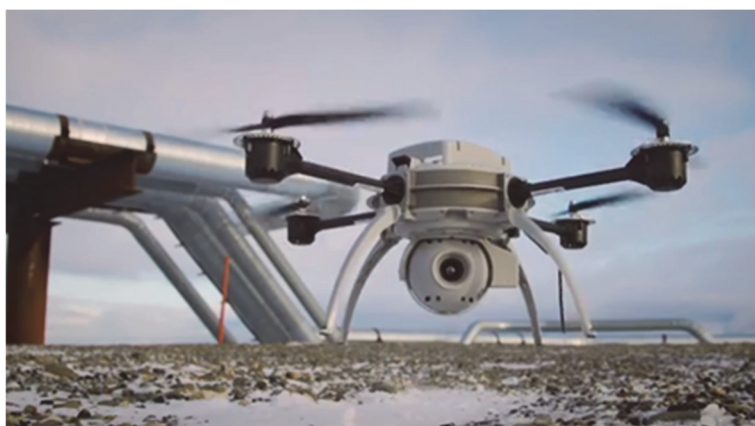
Slika 9. Dron s instaliranom kamerom i GPS sustavom navođenja ( www.eagleview.com )
