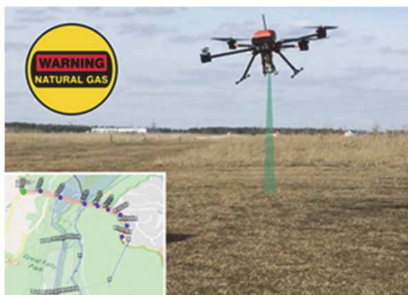
Slika 11. Dron s detektorom istjecanja prirodnog plina ( www.flyroutinely.com )
