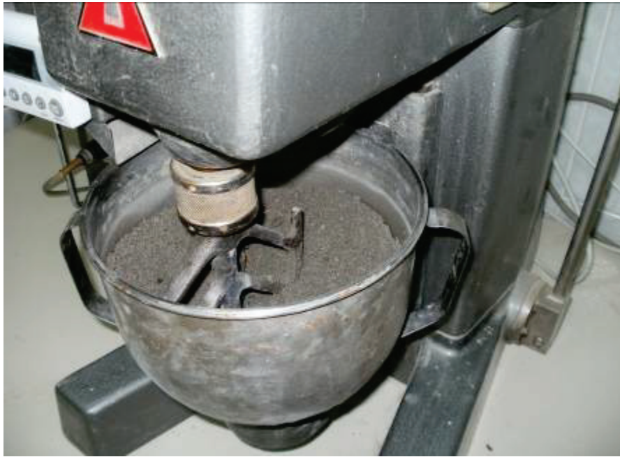
Slika 12. Miješanje betonske smjese
