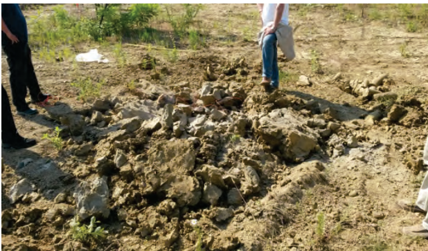
Slika 13. Nastali krater uslijed prevelike mase eksploziva i vlažnosti istražne bušotine.
