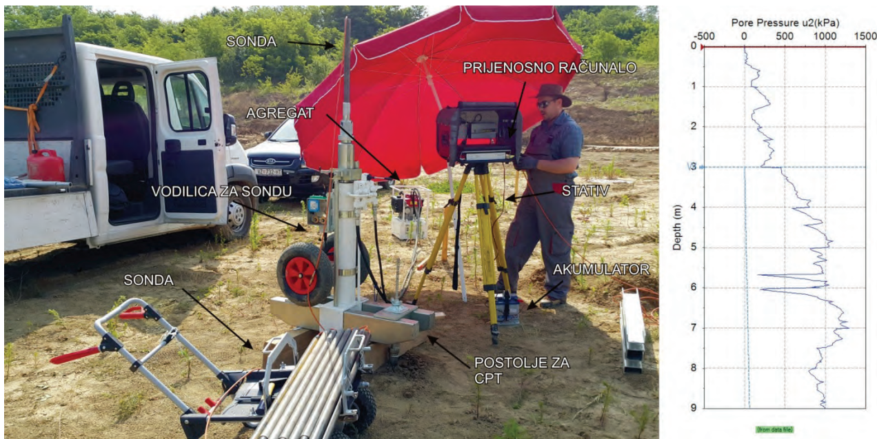
Slika 2. Oprema za izvođenje statičkog penetracijskog testa i primjer izmjere pornog tlaka.
