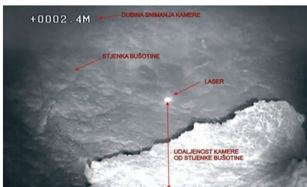
Slika 8. Snimak nastale šupljine dubinskom kamerom.
