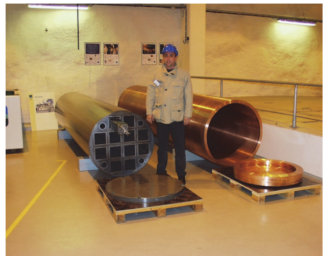
Slika 2. Metalni spremnici za istrošeno nuklearno gorivo u budućem odlagalištu VRAO i ING u Finskoj.
