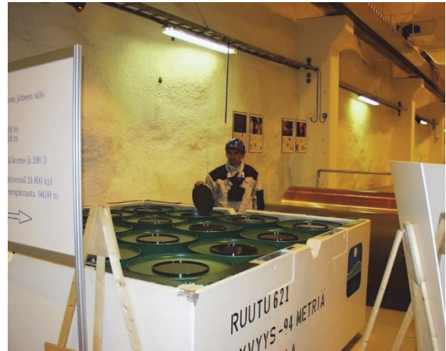
Slika 1. Kontejner s metalnim dvjestolitarским bačvama za pakiranje RAO u odlagalištu Olkiluoto u Finskoj.
