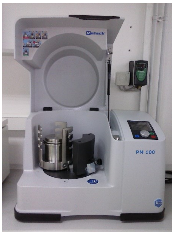
Slika 4. Kuglični ahatni mlin Retsch / PM 100
