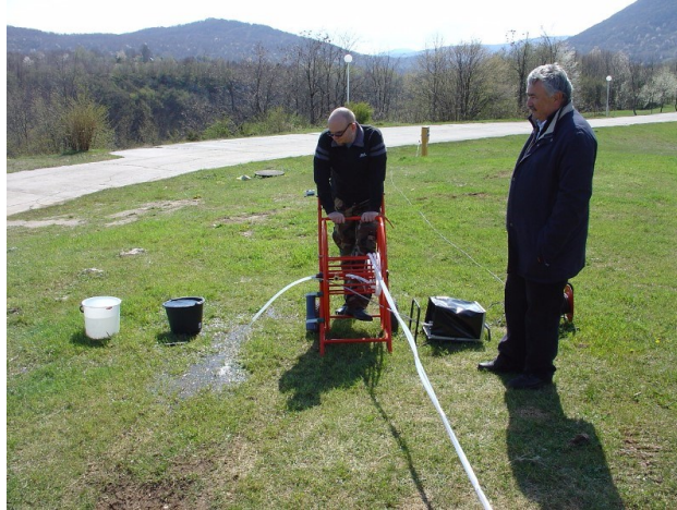
Slika 5. Probno crpljenje piezometra PJ-2, Autokamp Korana, (travanj 2008.)
