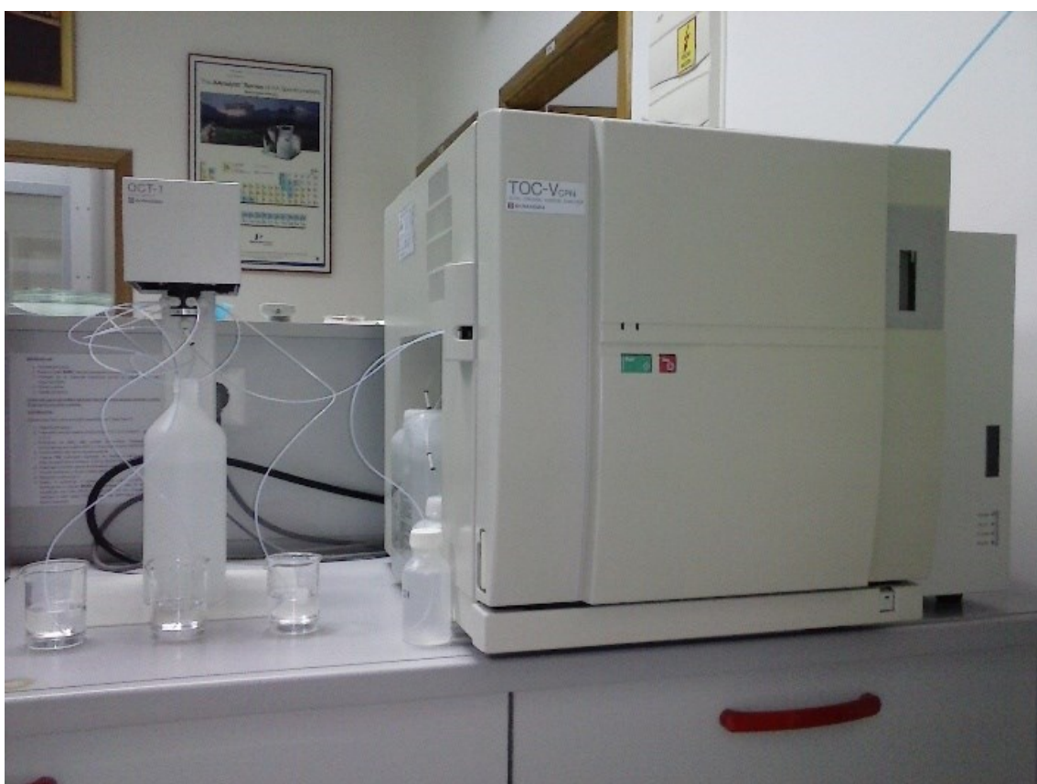
Slika 2. TOC/TN analizator SHIMADZU TOC-Vcpn + TN-1 + OCT-1, analiza ukupnog organskog ugljika
