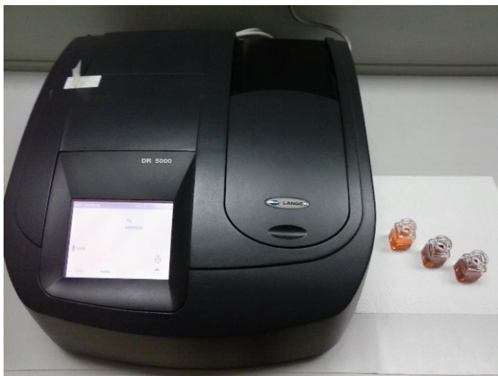
Slika 3. Spektrofotometar HACH DR5000, određivanje humusa
