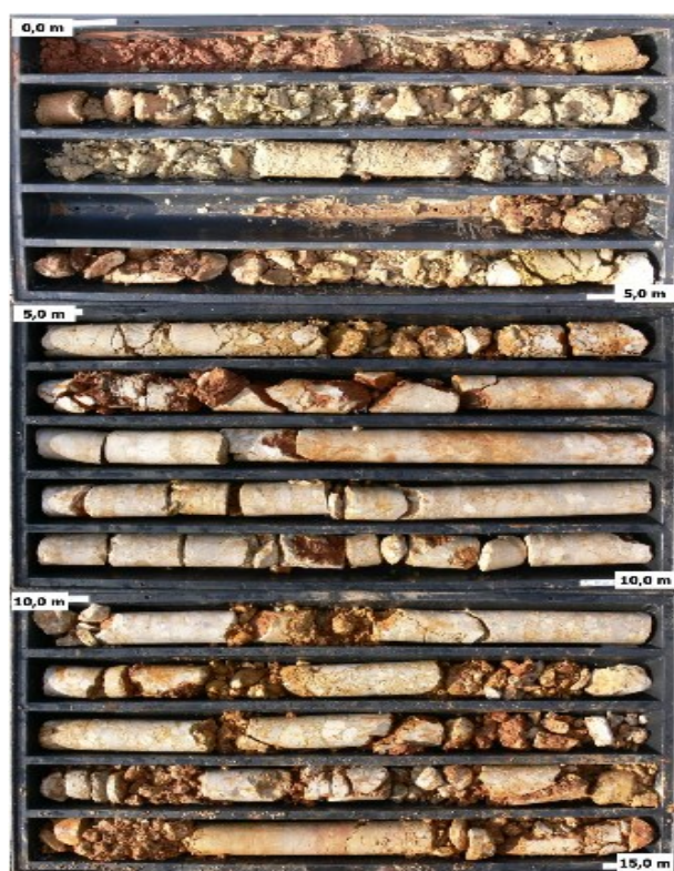
Slika 4. Prikaz jezgre istražne bušotine BF-22 (Grabar et al. 2016)
