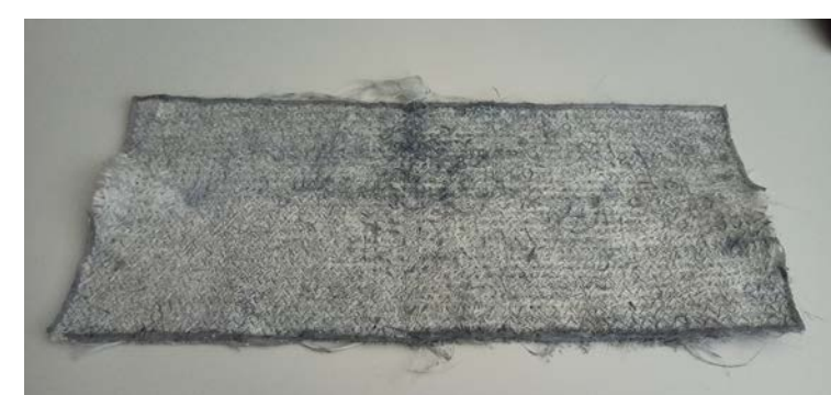
Mreža s TiO_2/CNT -GF immobiliziranim fotokatalizatorom
