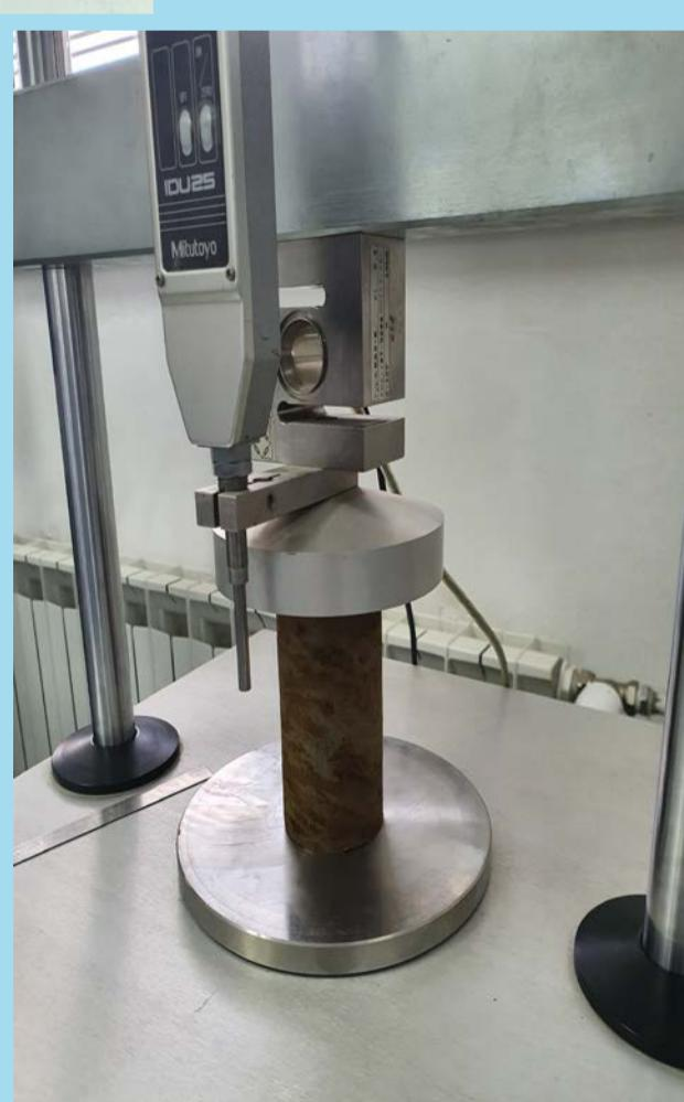
Brzina deformacije podešena na  $1\%/\text{min}$
