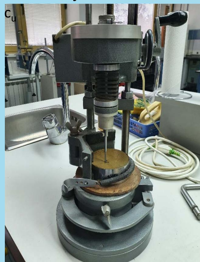
Odabrane su dimenzije krilaca sonde ( $H = D = 12.7 \text{ mm}$ ) te opruga torzijske krutosti  $A_1, k_t = 0.00091 \text{ N}^\circ$ ) Konstanta korištena u proračunima je  $K = 4290 \text{ mm}^3$
